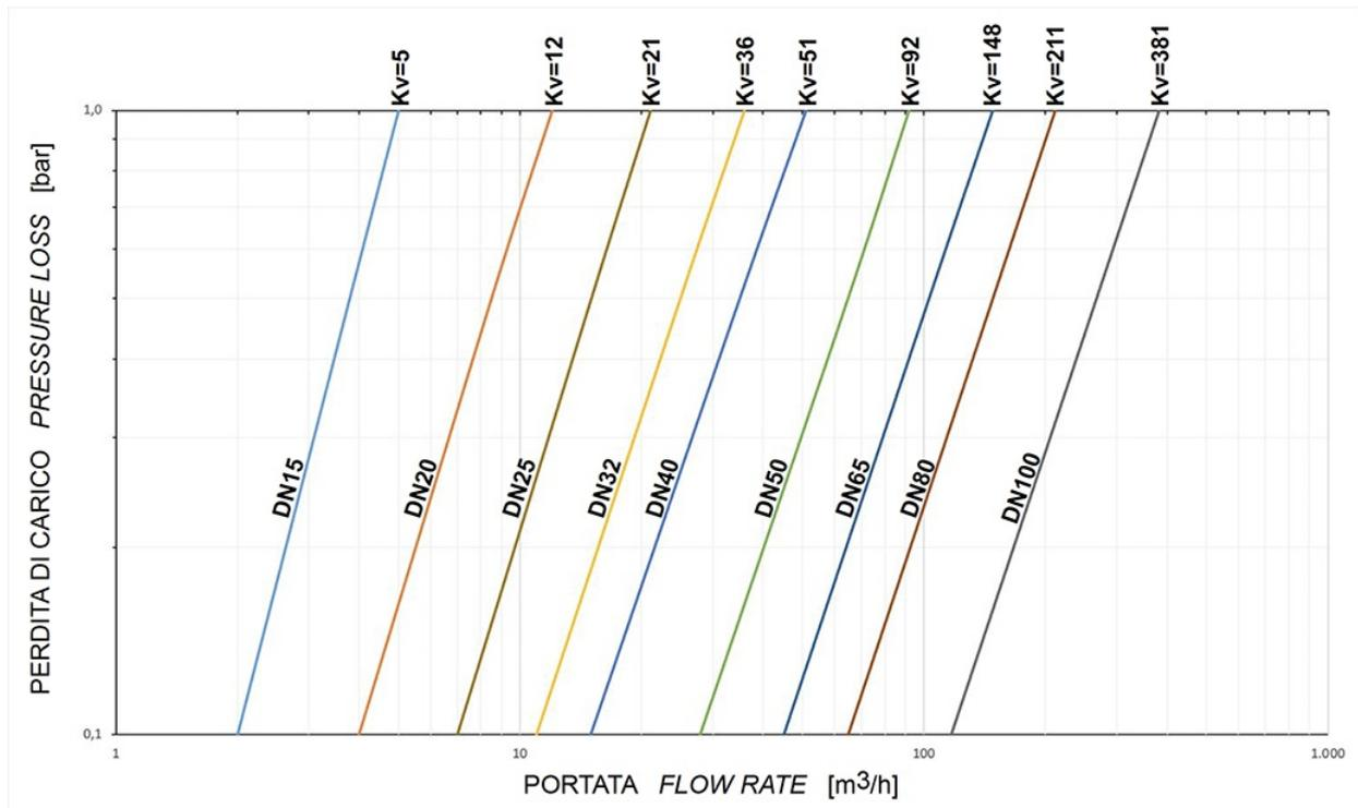
Il valore Kv è il valore di portata in m³/h (con acqua a 15°C) che provoca la caduta di pressione di 1 bar.
