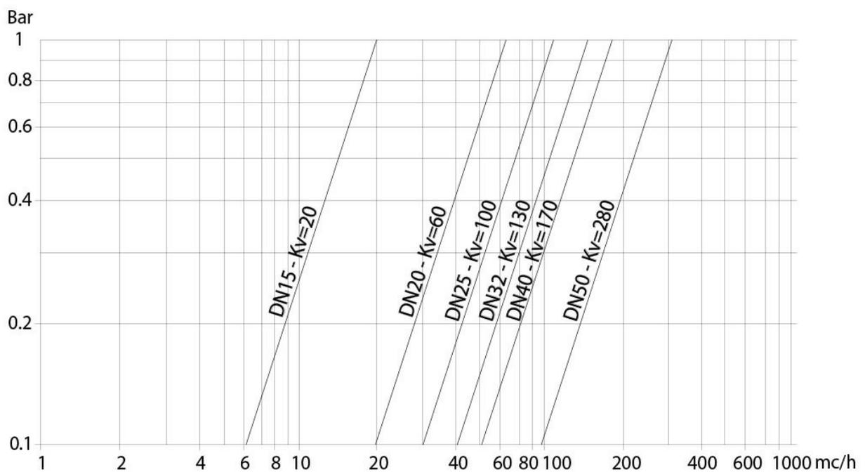
La valeur Kv est la valeur du débit en m<sup>3</sup>/h (avec de l'eau à 15°C) qui provoque une chute de pression d'1 bar.
