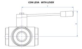
La versione con leva non ha la flangia montaggio attuatore a norma ISO 5211 e non è possibile montare alcun tipo di attuatore.
