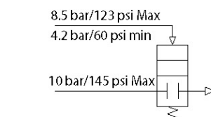
Schema di funzionamento nella configurazione a semplice effetto normalmente chiuso Spring return Normally closed VIP Working plan
