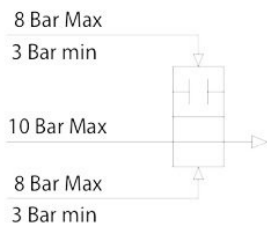
Schema di funzionamento nella configurazione a doppio effetto
