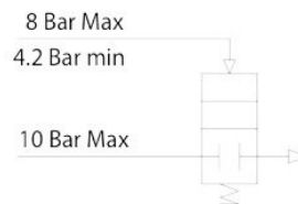
Schema di funzionamento nella configurazione semplice effetto normalmente chiuso
