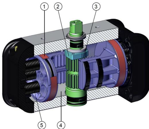
**1. Fasce di tenuta e scorrimento energizzate autolubrificanti.**
