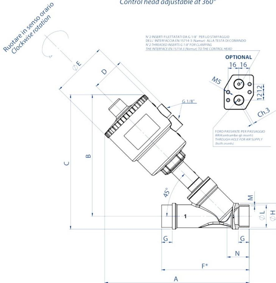
Esempio dell'interfaccia EN 15714-3 (Namur) assemblata alla testa di comando
