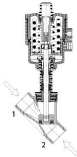
N.C. Normalmente chiusa bidirezionale. Con ingresso sotto l'otturatore si evita il colpo d'ariete.
